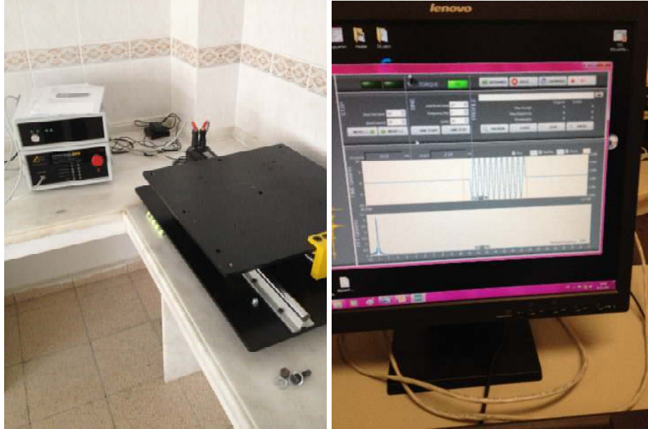
Şekil 2. Laboratuvar ölçekli sarsma tablası
